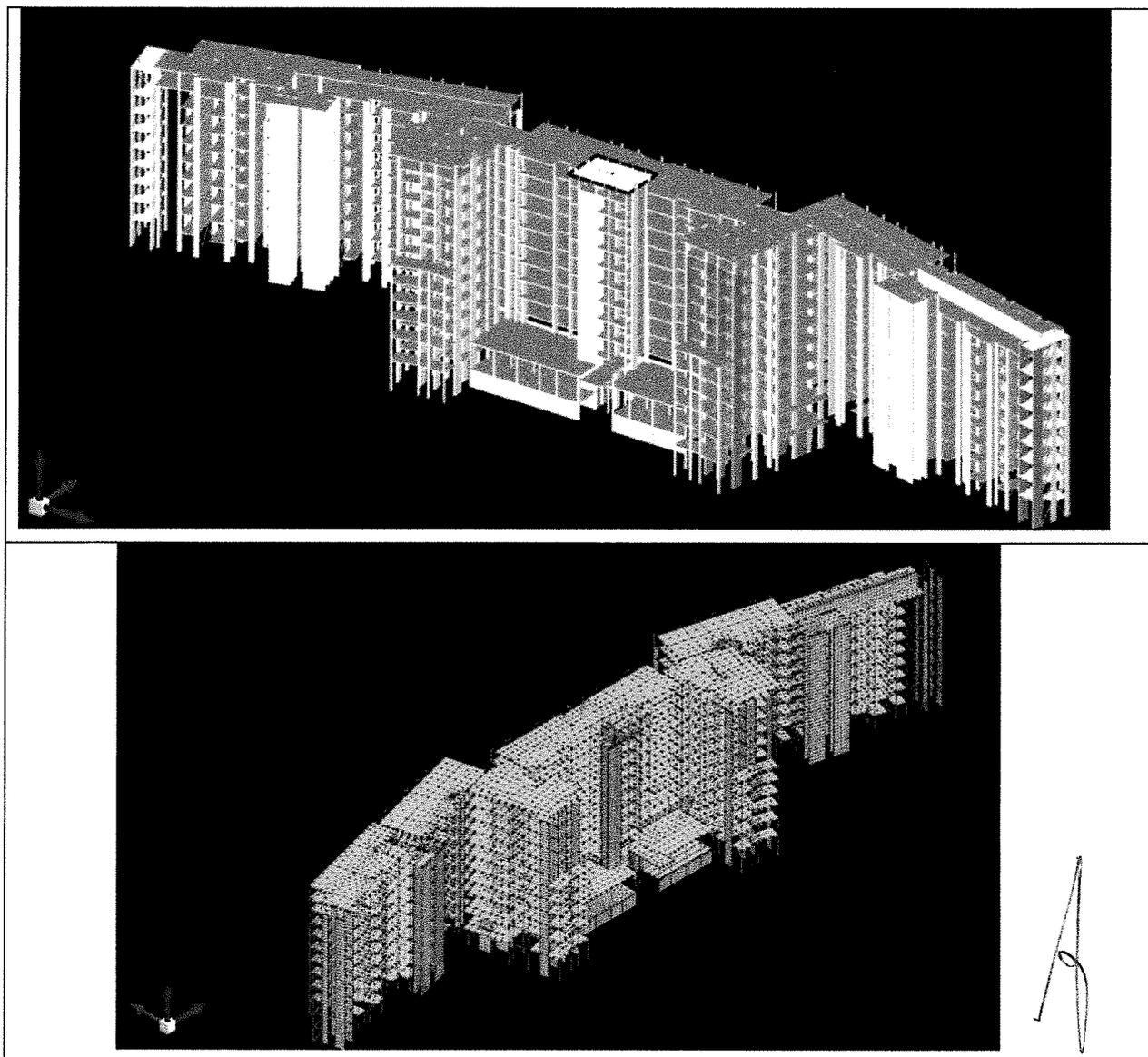
Fig. 3 Modello globale dei corpi collegati dagli shock trasmettitori con controventi dissipativi.
